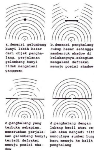
Gambar 3. Ilustrasi Difraksi Gelombang Bunyi [4].
