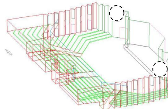
**Gambar 3.** Peletakan *speaker* sisi depan atas (simetri) (sumber: ECOTECH v5.20)
