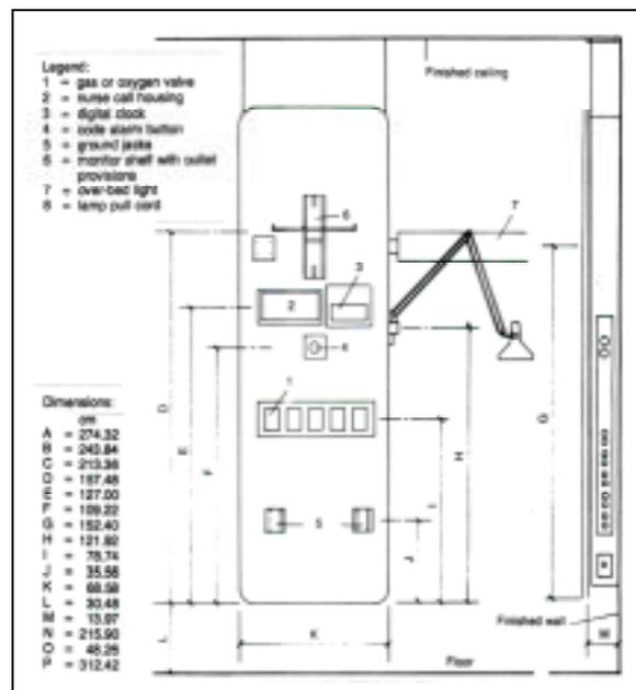
**Gambar 2.** Standar Panel Kontrol dan Peletakkannya
