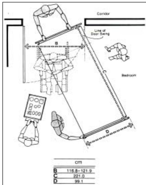
**Gambar 5.** Standar Lebar Pintu untuk Dilalui Tempat Tidur
